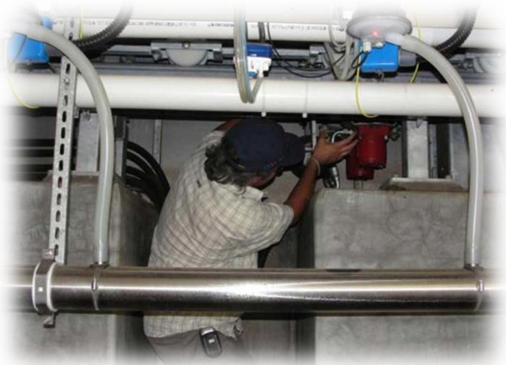
•普通转台挤奶机驱动单元维护保养必需停止运行。
